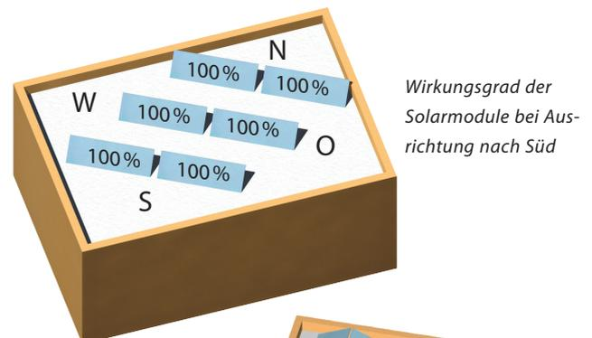
Wirkungsgrad der Solarmodule bei Ausrichtung nach Süd
